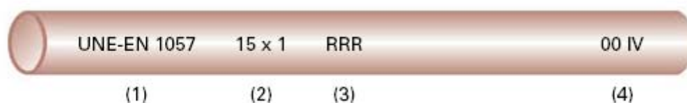
Figura 2.1. Marcado de tubo normalizado
